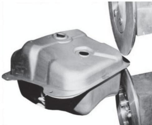
**Рисунок 2.** Шовная сварка топливного бака.
