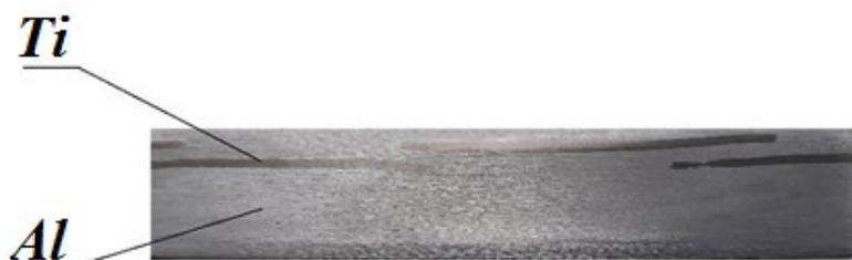
**Рисунок 2.** Макроструктура гетерогенного материала.
