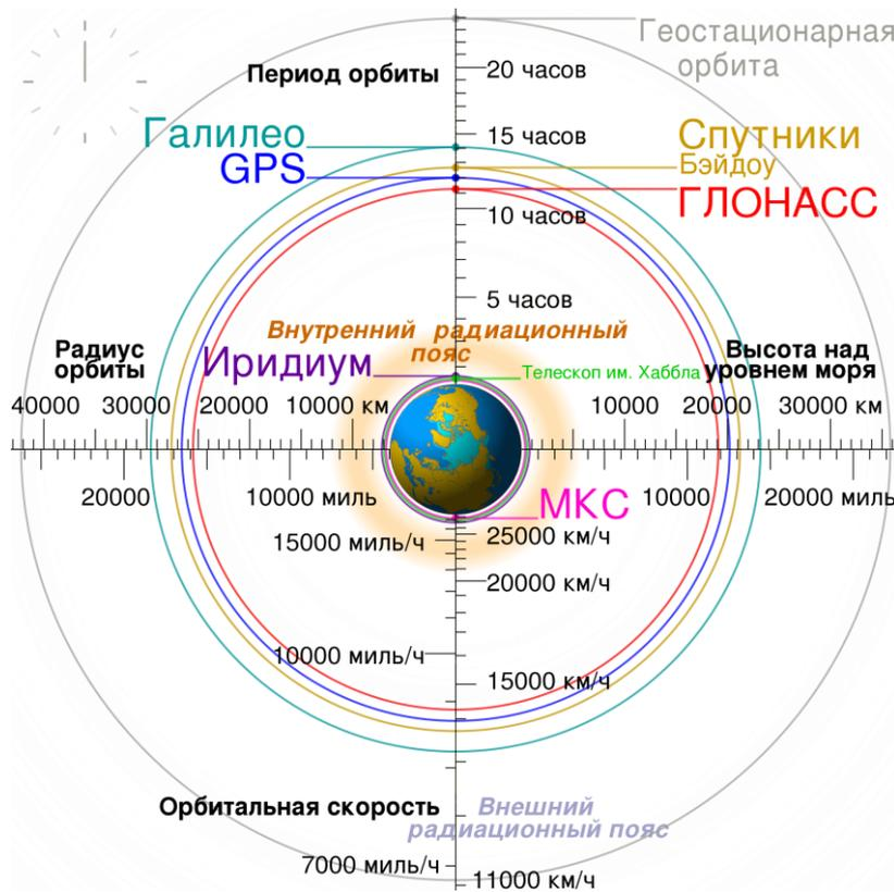
Рисунок 1. Орбиты разных спутниковых навигационных систем.
